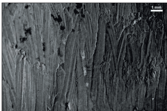
■ Obr. 9a Leštění křemenným oblázkem. Hlína byla při leštění stále značně plastická. Důsledkem jsou ostře vyčleněné fasety s patrným přehrnutím hlíny na koncích tahu nástroje a výrazný reliéf rýh.
