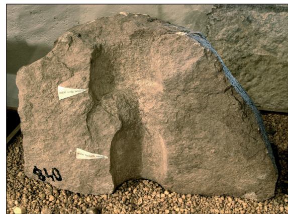
■ Obr. 3 Mlýnský kámen prasklý při vrtání středového otvoru. Patrné je vrtání dutým i špičatým vrtákem. Úprava na Kometě v Píseckých horách. Foto V. Komasová.
