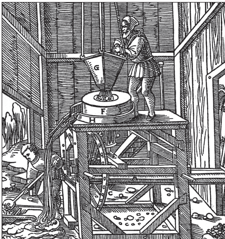
■ Obr. 9 Zlatorudný mlýn podle Georga Agricoli (1556).
