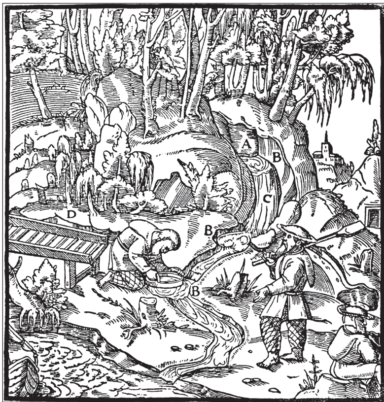
■ Obr. 3 Rýžování pomocí rýžovníkové pánve B a splavu D. Dřevoryt z díla G. Agricoli De Re Metallica Libri XII z roku 1556. Podle Ježek – Hummel 1933.
