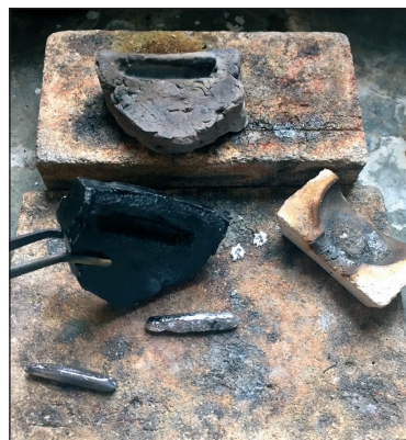
■ Obr. 12 Vyklopenie odliatku z formy.
