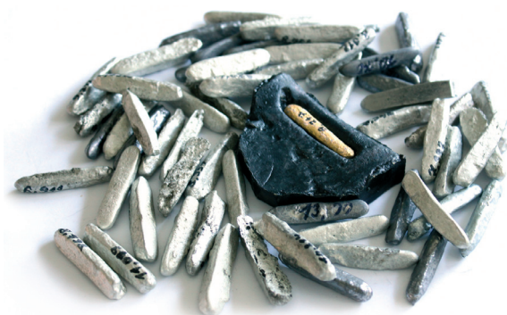
■ Obr. 14 Vyrobená forma so všetkými odliatymi ingotmi (62 ks).
