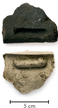
■ Obr. 3 Original a jeho lukoprenový odtlačok.
