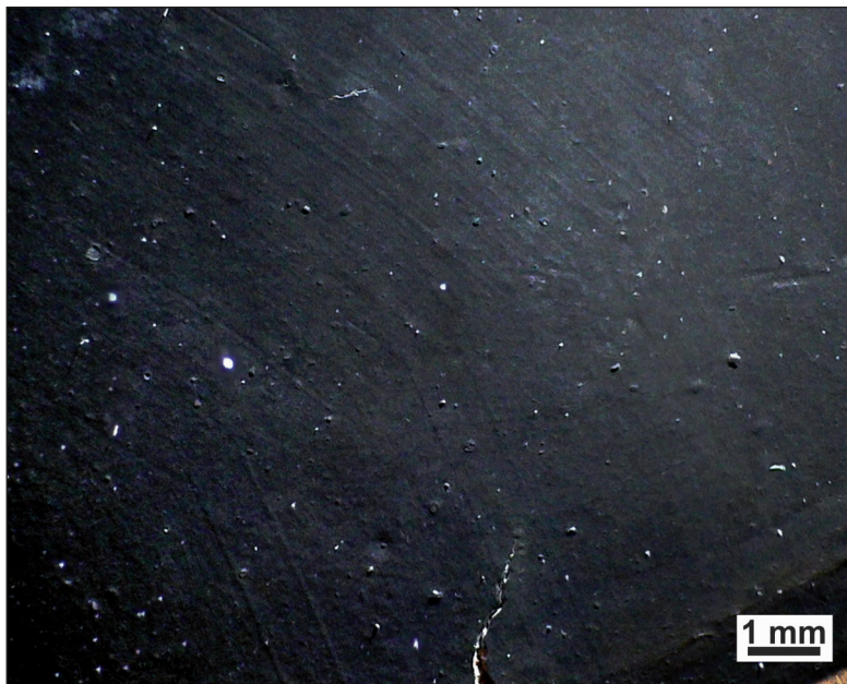
■ Obr. 7 Dochované tahy po štětcí použitém k plošnému pokrytí povrchu nádoby suspenzí.
