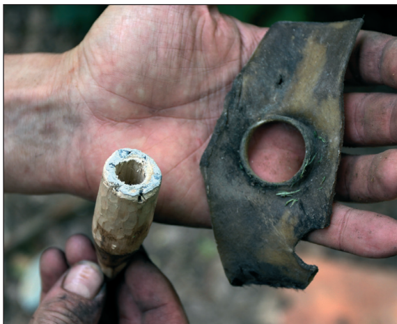
■ Obr. 22 Vodící přípravek ze surové hovězí a vrtací hlavice, vyrobená z probíjejího lískového kolíku.
