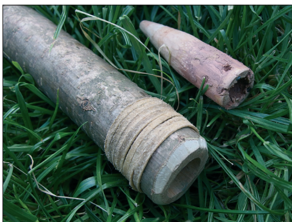
■ Obr. 23 Spodní konec tyčového vrtáku s vnitřním kuželovitým otvorem a vrtací hlavice s odpovídajícím zakončením. Tyčový vrták zpevněn proti roztržení pruhem surové kůže.
