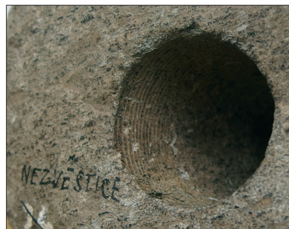
■ Obr. 11 Výrazně vyrytá spirála v horní části vrtu (inv. č. 20318, ZČM Plzeň).
