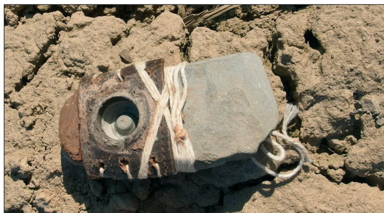
■ Obr. 16 Kozená příruba – vodící přípravek z vydláhané hovězí kůže (použit starý opasek).
