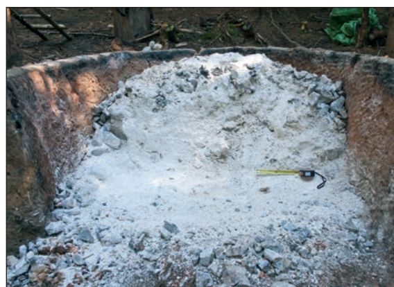
■ Obr. 11 Řez horní částí vsádky po dvouprostorovém výpalu.
