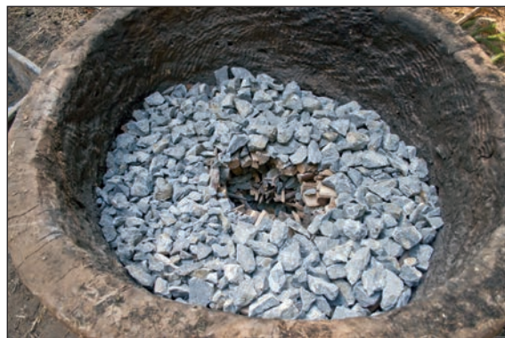
■ Obr. 3 Vrstva vápence v jednoprostorovém výpalu.
