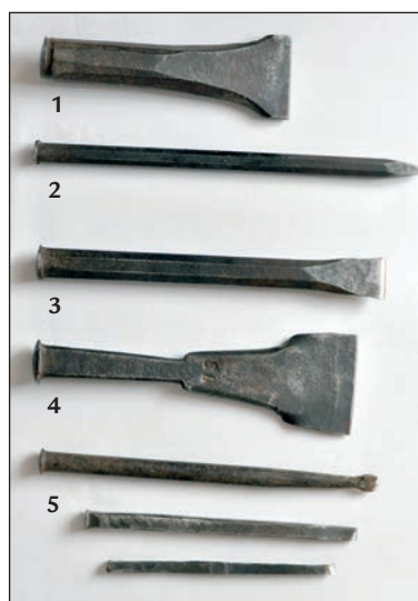
■ Obr. 7 Různé typy kamenických nástrojů užívaných v současné praxi: 1. prýskač, 2. špice, 3. dláto, 4. rýhovačka, 5. drobnější dlátka používaná při sekání otvorů (foto T. Mangel)
