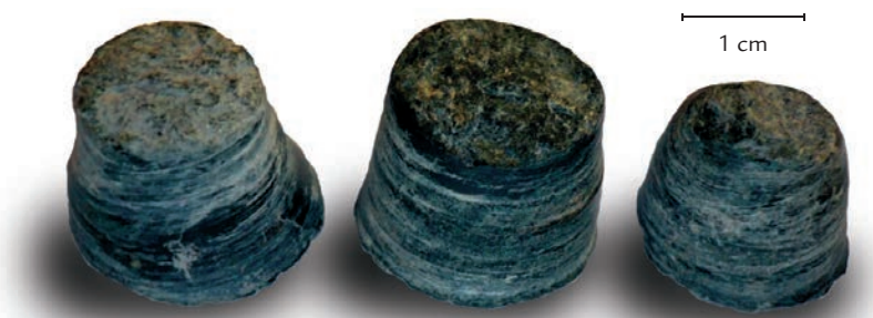
■ Obr. 14 Vrtání III, zelená břidlice typ Želešice, při vrtání jediného otvoru vznikly postupným odlomením tři vývrtky
