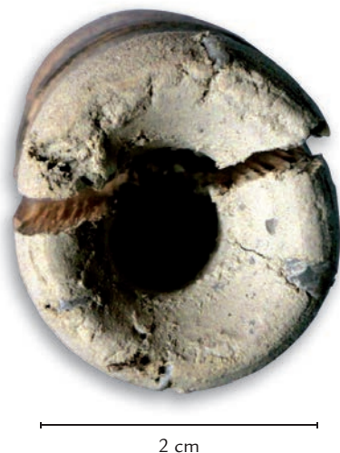
■ Obr. 7 Rozštípnutá vrtací korunka, vrtání II (pohled zvenčí a zevnitř)
