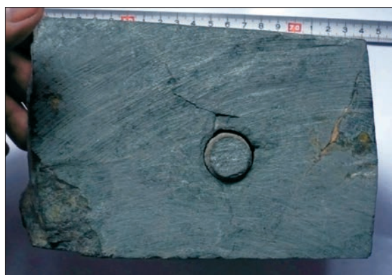
■ Obr. 12 Vrtání III, zelená břidlice typ Želešice, nahoře otvor po 25 hodinách práce, dole pohled na spodní část s otvorem a vsazenou vrtací korunkou a vývrtkem
