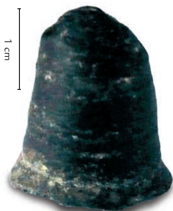
■ Obr. 10 Vrtání II, amfibolit, vývrtek s defektním vrcholem
