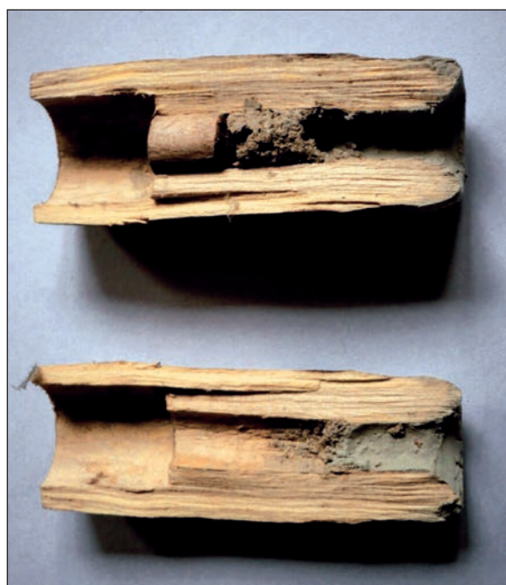
■ Obr. 7 Rozštípnutá vrtací korunka, vrtání II (pohled zvenčí a zevnitř)
