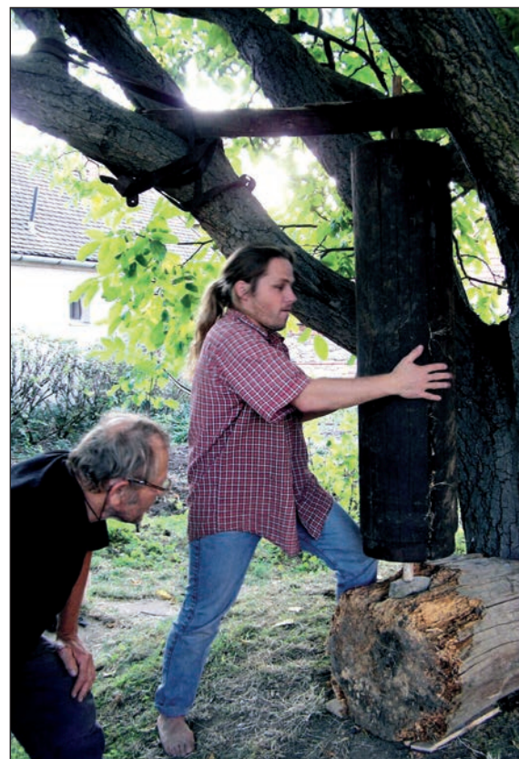
■ Obr. 1 Postup vrtání pomocí zavěšeného setrvačnicku po 5,5 h práce
