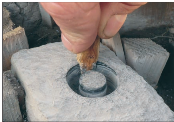
■ Obr. 23 Vrtání IV, metabazit typu Pojizeří, čištění otvoru při vrtání za sucha a bez použití abraziva
