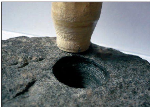
■ Obr. 8 Vrtání II, amfibolit, detail otvoru a opotřebení vrtací korunky při použití křemenného a rohovcového abraziva a vyvrtaný otvor s vloženou vrtací korunkou a vývrtkem
