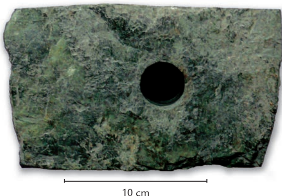
■ Obr. 8 Vrtání II, amfibolit, detail otvoru a opotřebení vrtací korunky při použití křemenného a rohovcového abraziva a vyvrtaný otvor s vloženou vrtací korunkou a vývrtkem
