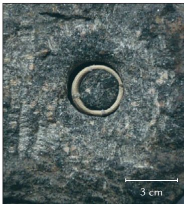
■ Obr. 8 Vrtání II, amfibolit, detail otvoru a opotřebení vrtací korunky při použití křemenného a rohovcového abraziva a vyvrtaný otvor s vloženou vrtací korunkou a vývrtkem
