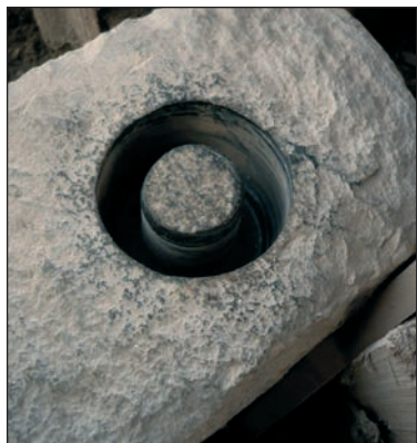
■ Obr. 22 Vrtání IV, metabazit typu Pojizeří, provrt po 75 hodinách práce (vlevo) a 135 hodinách práce (vpravo)
