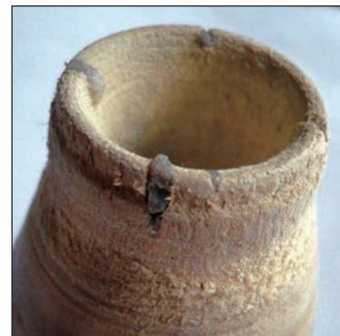
■ Obr. 9 Vrtání II, amfibolit, vrtací korunka po 64 hodinách práce při použití mokrého abraziva
