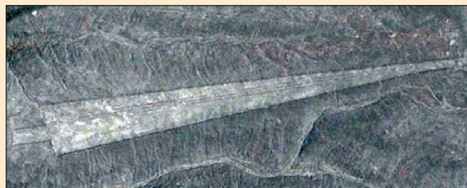
■ Obr. 16 Tři souběžné čáry – stopy vyryté saněmi splétacího stroje.
