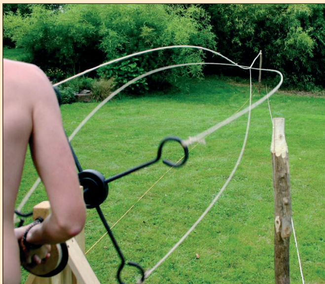
■ Obr. 12 Odstředivou silou a vlastní vahou jsou vlákna smýkána po zemi. Trojúhelníkové pracovní plochy proto musí být vymetené a bez kamínků, na kterých by se vlákna mohly zachytit.
