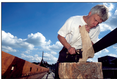
■ Obr. 3 Loď byla stavěna v loděnici dánského Viking Ship muzea v letech 2000 až 2004 replikami vikingských nástrojů a pomocí původních dobových postupů.
