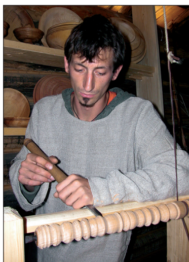
■ Obr. 7 A Kůly pro stáj byly umístěny do děr v zemi. Vztyčili jsme je ručně. B V domě zpracovatele dřeva byl postaven soustruh na výrobu dřevěných nádob, jako jsou mísy a talíře. C Během Keltského festivalu ve Schwarzenbachu se předvádějí keltská řemesla.
