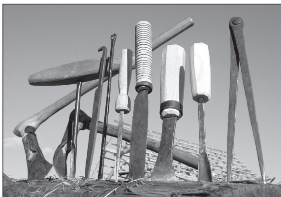
■ Obr. 2 Kovové rekonstrukce nástrojů, které jsme použili během rekonstrukčních prací: sekery, teslice, poříz, nože, dlátko, lžícové vrtáky, šídla atd. (barevná verze obr. 1 a 2 je na zadní straně obálky časopisu)
