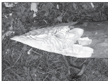
■ Obr. 10 Zahrocený konec pilotu použitého v experimentu
