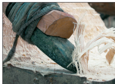
■ Obr. 6 Detail: ostrá čepel teslice odsekává kousek dřeva.
