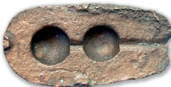
■ Obr. 14 Polovina kadluby s licím kanálkem a dutinami pro dvě střely. Na bocích a jednom konci tři výstupky zámku.
