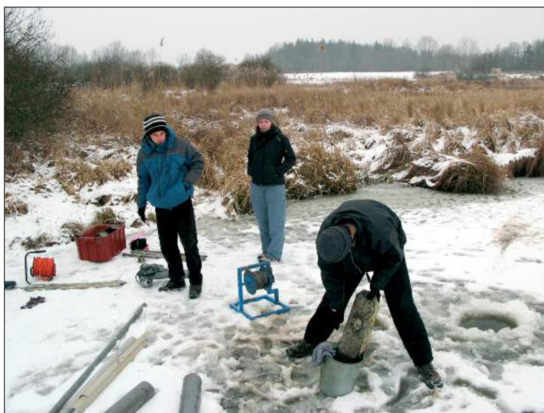
■ Obr. 4 Odběry profilů sedimentů zaniklého jezera Schwarzenberg na Třeboňsku. V mrazivém zimním období je možné provozovat jádrové vrtné zařízení ze zamrzlé hladiny rybníka. Foto P. Pokorný.
