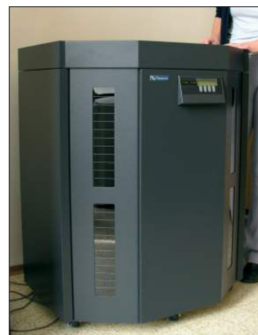
■ Obr. 4. Jukebox Plasmon M104–910–X na 104 magnetooptických disků, jedno ze zálohovacích zařízení pro Digitální archiv ARÚP.
