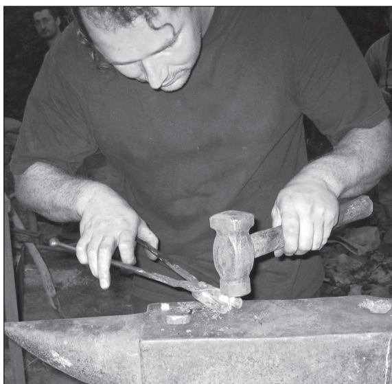
■ Obr. 6 Kování kousků železa
