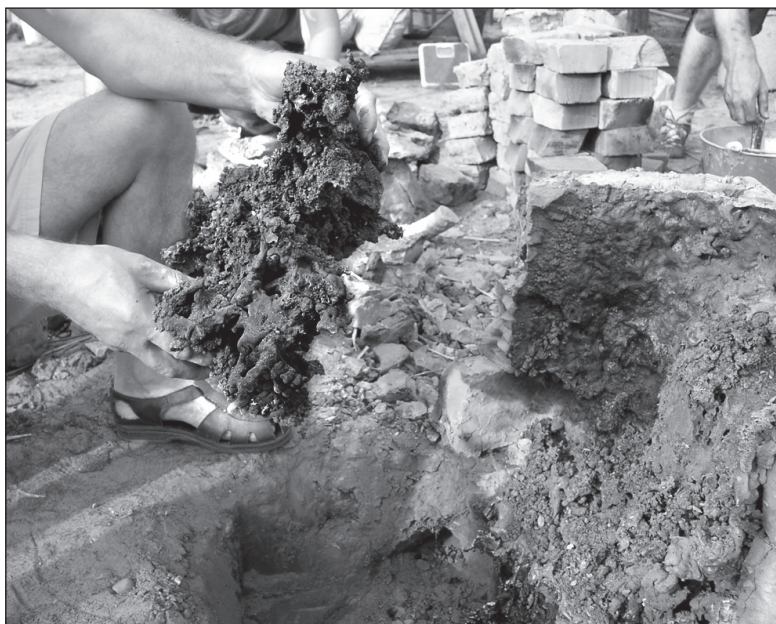
■ Obr. 5 Struska vzniklá při testu II
