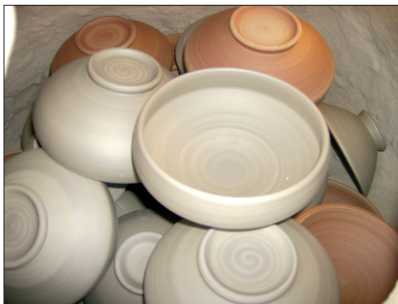
■ Obr. 11 Experiment 2: keramické polotovary vložené do pece
