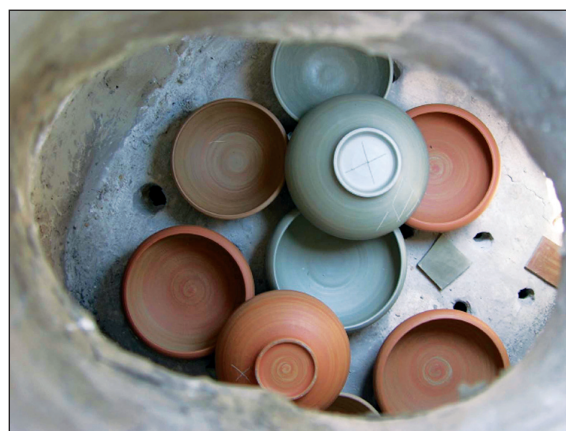
■ Obr. 2 Experiment 1: ukládání polotovárů do pece
