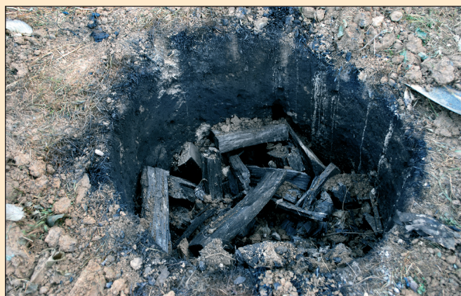
■ Obr. 10 Pohled na zuhlená polena a stěny silně pokryté dehtem, výpal č. 4
