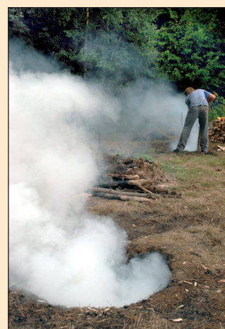
■ Obr. 4 Silné dýmání, zapříčiněné tlakovou níží a vlhkým dřevem
