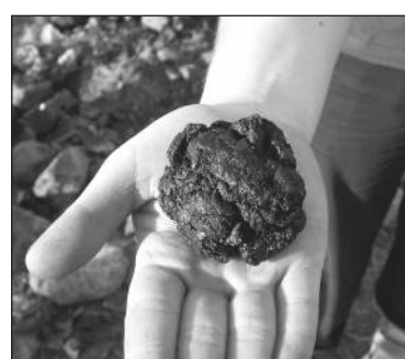
■ Obr. 7 Vyrobený dřevěný dehet byl silně kontaminován dřevěným uhlím a nepřeměněnou březovou kůrou.
