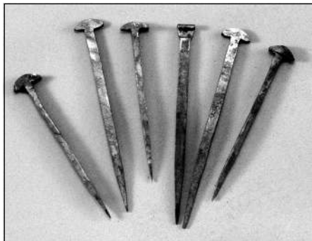
obr. 9 Repliky hřebíků použité v konstrukci střechy stavby B7. (foto archiv Archaia) ■
