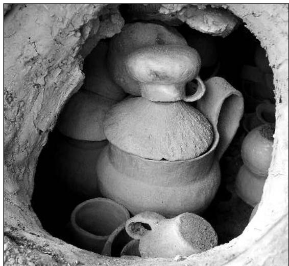
Obr. 34 Vsázka keramiky ve vertikální dvoukomorové peci po 5. výpalu (13. - 14. 4. 2002). ■
