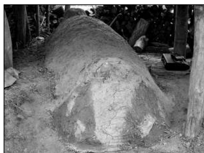
Obr. 23 Pec uzavřená po výpalu pro potřeby redukce. ■
