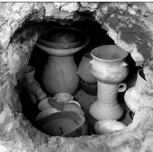
Obr. 34 Vsázka keramiky ve vertikální dvoukomorové peci po 5. výpalu (13. - 14. 4. 2002). ■
