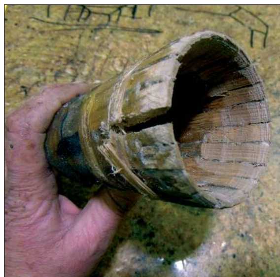
■ Obr. 14 Vrtací korunka před tepelnou destrukcí (foto J. Fieger).
