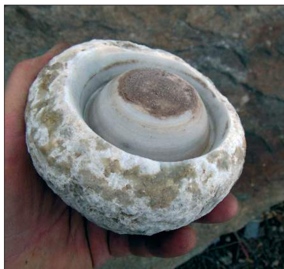
■ Obr. 15 Výsledek části experimentu po destrukci vrtací korunky (foto J. Fieger).
