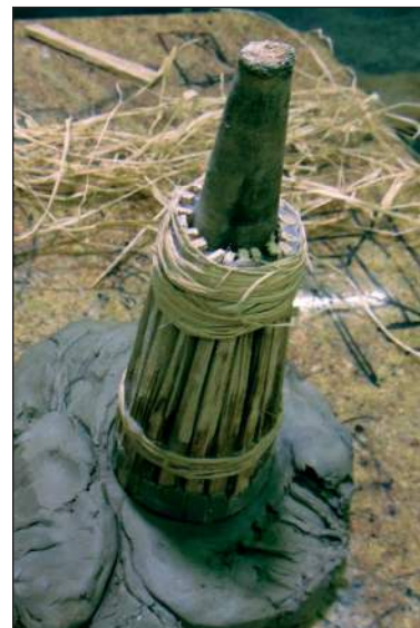
■ Obr. 10 Fixování lamel lýkem před zátěrem smoly (foto J. Fieger).
