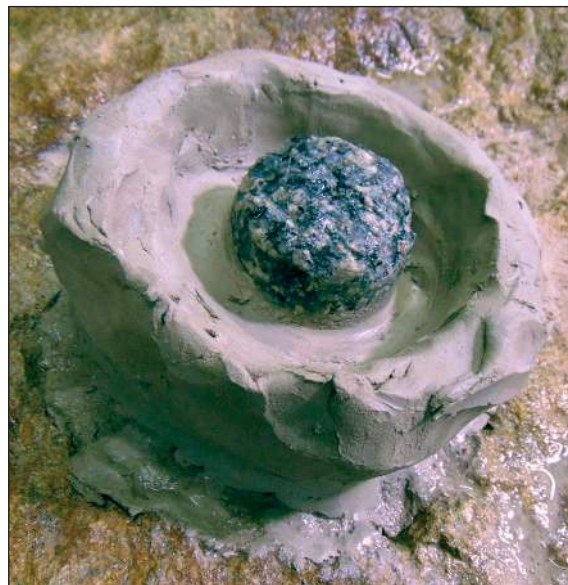
■ Obr. 13 Smolou upevněné jádro pro stabilizaci korunky (foto J. Fieger).
