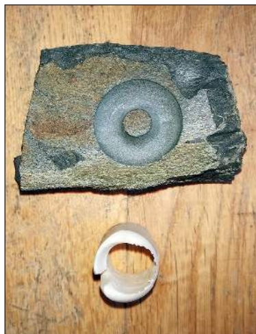
■ Obr. 4 Pokus 28, vrtání metabazitu typu Jizerské hory kostí pomocí jednosměrného vrtáku (I. Dohnálková; foto MD).
