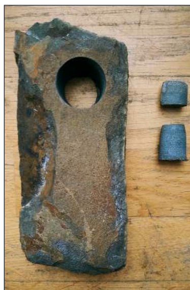
■ Obr. 24 Pokus 50, vrtání kulmského prachovce kostí pomocí dvousměrného vrtáku (K. Kučírek; foto MD).
