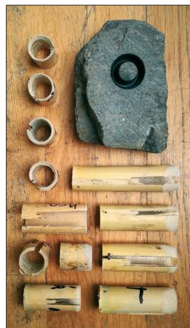
■ Obr. 16 Pokus 41, vrtání čediče rákosem pomocí dvousměrného vrtáku (K. Kučírek; foto MD).
