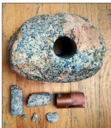
■ Obr. 14 Pokus 39, vrtání žuly mědí pomocí dvousměrného vrtáku (M. Drahorád; foto MD).
