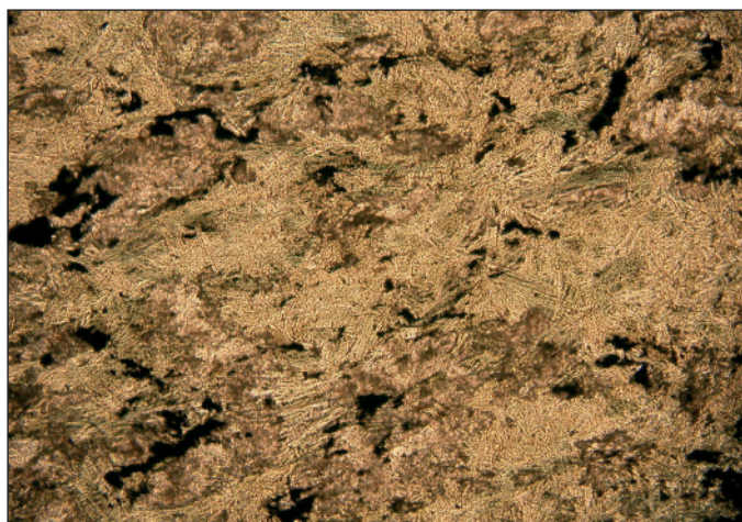
■ Obr. 30 Petrografický výbrus nefritoidního metabazitu z Velkých Hamrů (foto AP); vlevo s 1 nikolem, vpravo zkrřížené nikoly.
