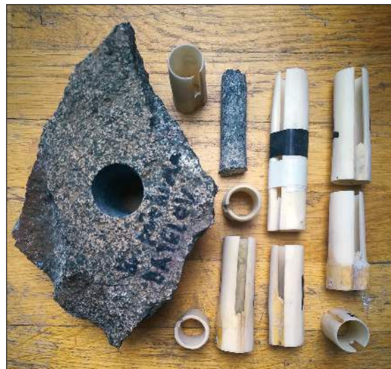
■ Obr. 21 Pokus 47, vrtání dioritu kostí pomocí dvousměrného vrtáku (K. Kučírek; foto MD).
