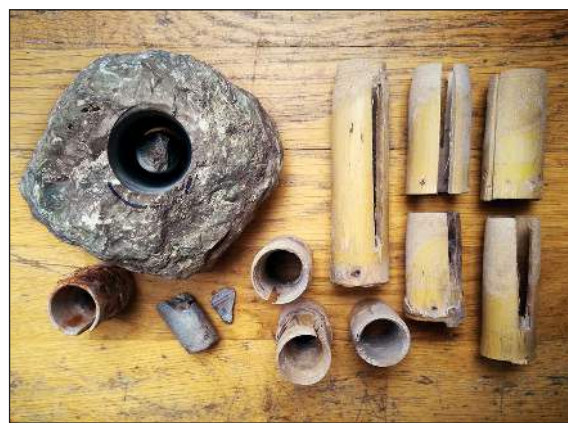
■ Obr. 10 Pokus 35, vrtání vápence rákosem pomocí dvousměrného vrtáku (K. Kučírek; foto MD).
