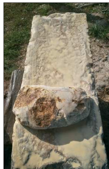
■ Obr. 2 Broušení kusu mramoru na brusku z hořického pískovce; za 16 h 50 min bylo odbroušeno 3142 g s cílem upravit sílu kamene na rozměr hloubky budoucího otvoru (foto MD).
