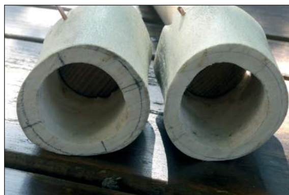
■ Obr. 3 Upevnění vrtáků ze stehenní kosti hovězího dobytka na hůlky dvojsměrné vrtačky před vnějším zbrúšením kosti na potřebnou sílu vrtáku (příprava S. Lukš; foto RT).
