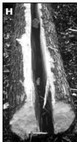
Štípání kmene dřevěnými klíny (H); začistění spojů při stavbě dřevěné konstrukce (I)
