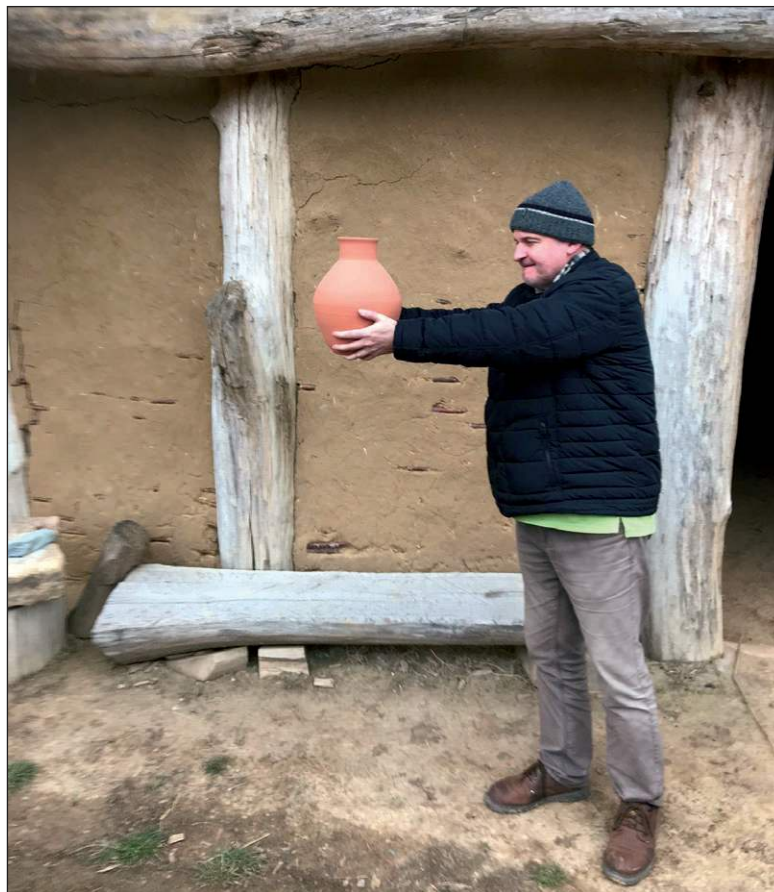
■ Obr. 2 Upuštění nádoby z výšky 150 cm, vektor pádu směřoval směrem ke dnu nádoby.
