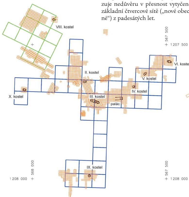
■ Obr. 4 Mikulčice-Valy. Kontrola historických měřických sítí. Okrová barva – historické čtvercové sítě výzkumu vynesené dle původní plánové dokumentace. Modrá a zelená barva – rekonstrukce dvou hlavních historických, kontinuálně užívaných měřických čtvercových systémů (modře – „nový obecný čtvercový systém“, zeleně – „obecný systém předhradí“) podle aktuálního zaměření bodů sítě 50 × 50 m vytyčených v minulosti a dodnes stabilizovaných pomocí zabetonovaných železných trubek. Grafika J. Šindelář.
