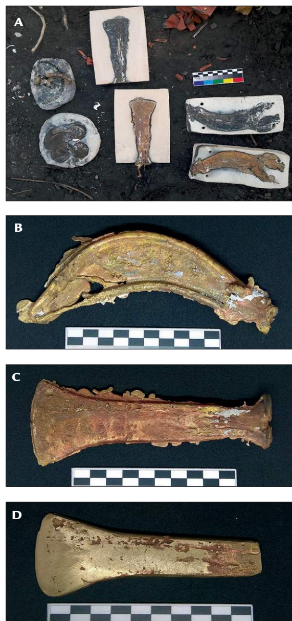
■ Obr. 4 A experimentální výroba replik v bronzové peci, celkem šest forem; B surový odlitek bronzového srpu; C surový odlitek bronzové sekery před broušením a leštěním; D hrubý odlitek bronzové sekery po dvou hodinách práce.
