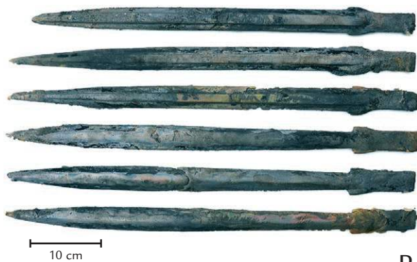
■ Obr. 1 A podoba jednoho dílu dvoudílné formy před tavbou; B surové odlitky bronzových seker, po vychladnutí a otevření formy; C hrubé odlitky bronzových nožů, po odstranění vtoků a výfuků; D hrubé odlitky bronzových mečů, po vyjmutí z forem a odstranění vtoků a výfuků.
