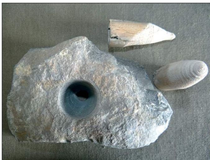
■ Obr. 22 Pokus 17 – vápenec vrtaný plným bukovým vrtákem s tužkovým tvarem hrotu.
