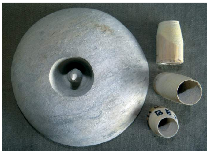
■ Obr. 16 Pokus 11 – opuka vrtaná upraveným bezovým vrtákem.
