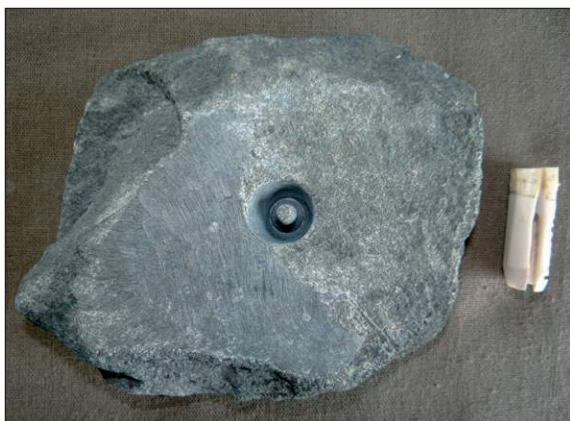
■ Obr. 8 Pokus 1 – metabazit typu Jizerské hory. Cílem pokusu bylo testovat málo upravený vrták ze srnčí kosti. Díky tomu vznikl otvor i vývrtek menšího průměru. Ukázala se nutnost úpravy vrtáku a přesívání brusiva. Pokus byl přerušen, ponechán byl počáteční vývrtek jako srovnávací materiál.
