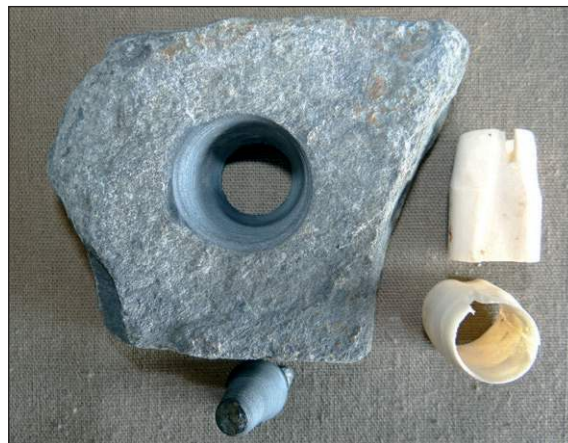
■ Obr. 12 Pokus 7 – metabazit typu Jizerské hory vrtaný kostěným vrtákem z jelení kosti.
