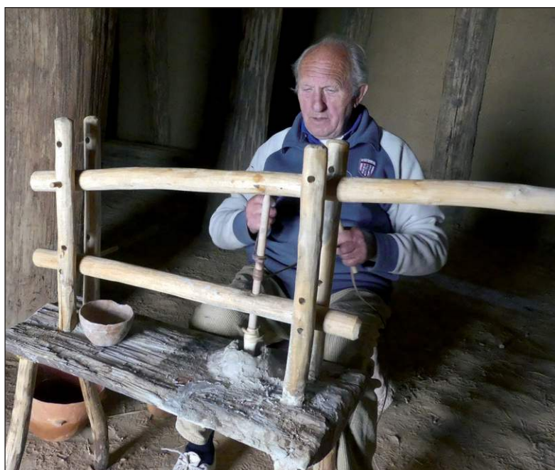
■ Obr. 6 Konstrukce dvojsměrného vrtáku použitého při pokusech. Vrták je upevněn ve dvou bodech.
