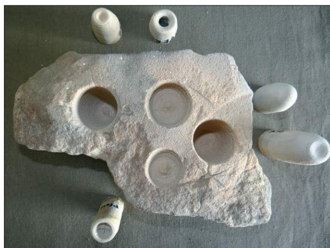
■ Obr. 19 Pokus 14 – pískovec měkký vrtaný: zleva nahoře dubovým plným vrtákem zaobleným, dubovým plným vrtákem plochým, bukovým vrtákem s tužkovým hrotem, dole bezovým neupraveným vrtákem (kámen změknl máčením brusiva a po vyschnutí opět ztvdnul), na dně otvorů vznikly velmi drobné výčnělky.
