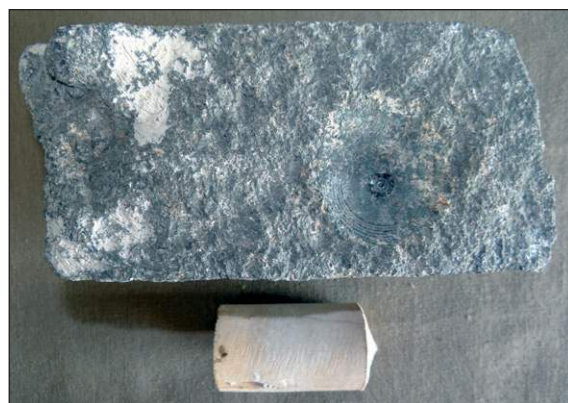
■ Obr. 15 Pokus 10 – gabro vrtané plným jasanovým vrtákem většího průměru.
