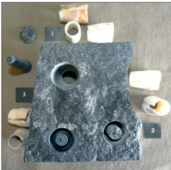
■ Obr. 9 Pokus 2 (9: 1) – upravený vrták z kosti jelena na amfibolitu z ložiska Markovice u Čáslavi (dovrtaný), použito bylo brusivo z křemene, silicitu a jaspisu. Vyzkoušena byla zátěž různé hmotnosti. Jako optimální se ukázala být hmotnost 360 g. Vyzkoušen byl i kožený vrták z vyschlé hovězí kůže, aby byla rozšířena možná škála použitých materiálů. Neosvědčil se. Pokus 3 (9: 2) – upravený vrták z kosti jelena na amfibolitu z ložiska Markovice u Čáslavi (dovrtaný do spodního poškození kamene, vývrtek ponechán, patrně je tenké mezikruží). Pokus 4 (9: 3) – upravený vrták z bezu (otvor nedokončen).
