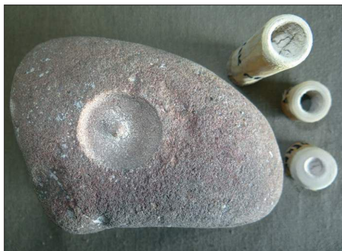
■ Obr. 17 Pokus 12 – pískovec/slepenec vrtaný neupraveným bezovým vrtákem.
