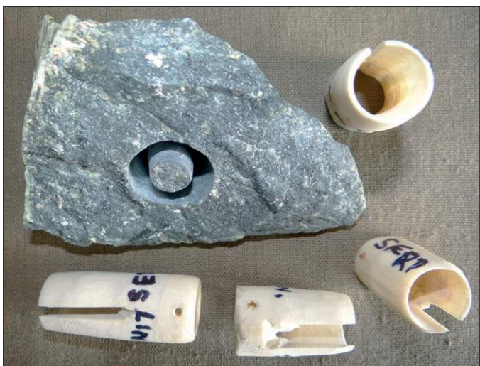
■ Obr. 24 Pokus 19 – serpentinit vrtaný kostěným upraveným vrtákem z jelena.
