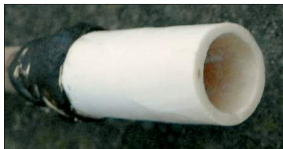
■ Obr. 2 Kostěný válcovitý vrták jako příklad, vrták používaný při zde uvedených pokusech.
