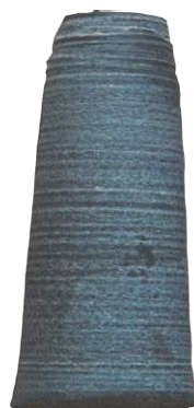
■ Obr. 8 Větší vývrtek pokusu 1 s rýhami po obvodu; ty mohou (a nemusí) vzniknout v závěrečné fázi vrtání
