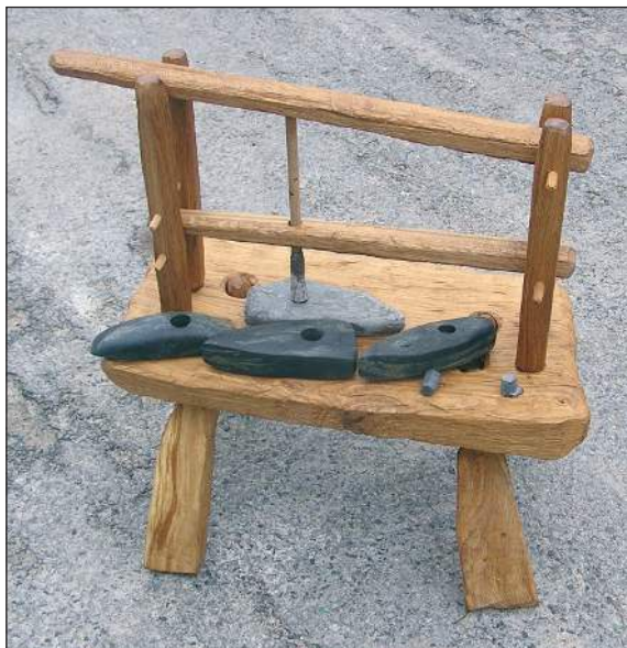
■ Obr. 8 Vrtací stolice s pokusnými vývrty.
