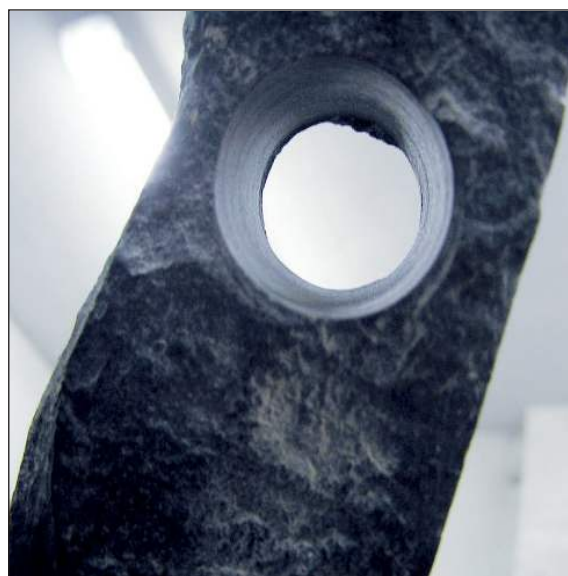
■ Obr. 5 Detail pokusného vývrtu.
