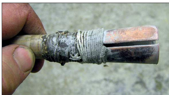
■ Obr. 3 Kuželový vrták z mědi.
