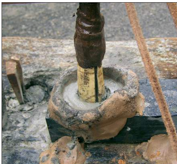
■ Obr. 9 Vrtání rohovinou ve vodní lázni.
