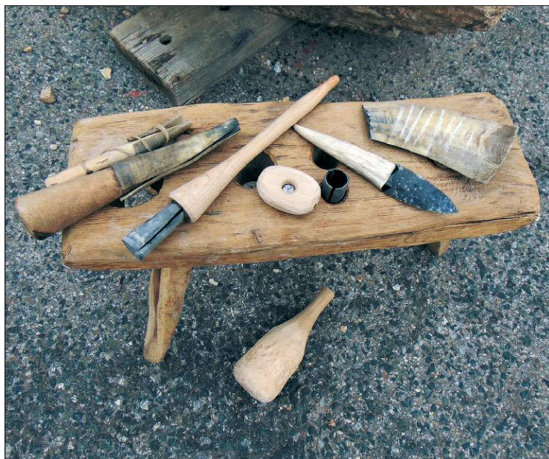
■ Obr. 7 Souprava na výrobu vrtáku z rohoviny.
