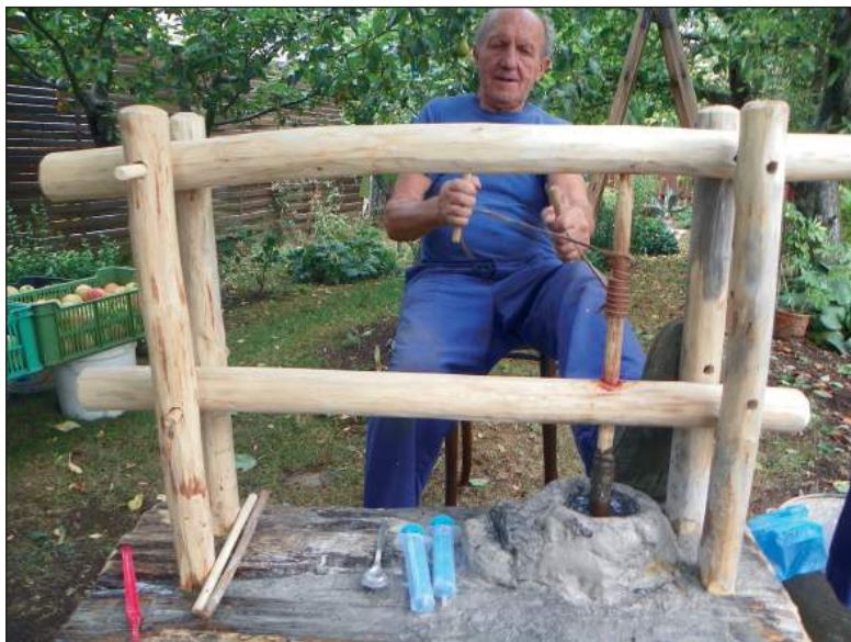
■ Obr. 15 Vrtací souprava s dvojsměrným vrtákem konstrukce dle J. Fiegra.
