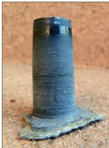
■ Obr. 20 Vývrtek jako jeden z výsledků pokusu – v horní části oleštěný vnitřní stranou prvního vrtáku.
