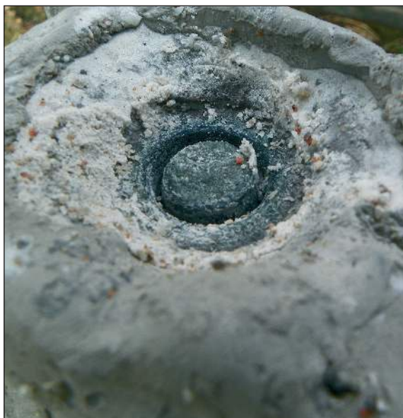
■ Obr. 17 Počáteční rýha budoucího otvoru s rozptylem zbytků hrubého ostříva (hrubost 1).
