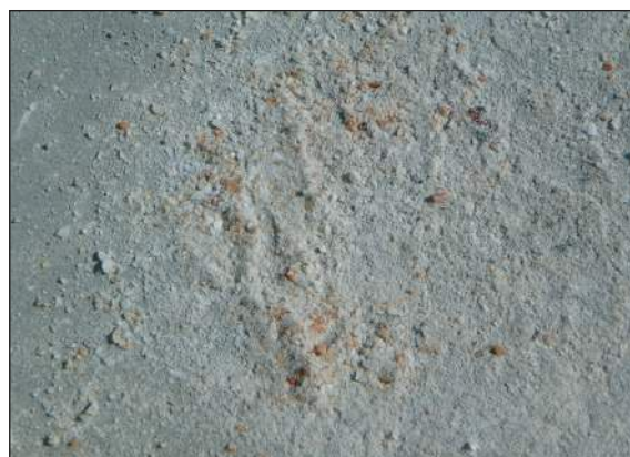
■ Obr. 14 Nulové opotřebení podložky z jemného pískovce po drcení křemene.
