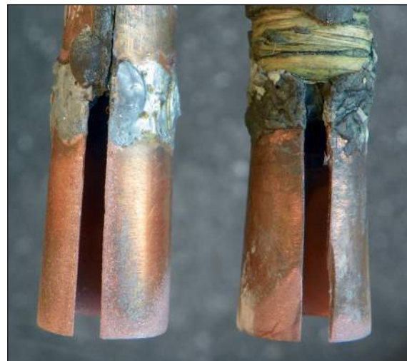
■ Obr. 19 Více kónický první vrták pokusu (vpravo) a více válcovitý vrták k pokračování vrtání.
