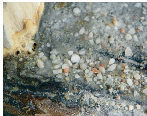
■ Obr. 22 „Archiv“ na vrtací soupravě: různé stupně rozmělnění a opotřebení brusiva z křemene.
