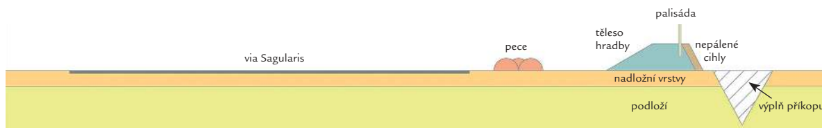
■ Obr. 4 Schéma kolmého řezu modelovaného opevnění krátkodobého tábora v Charvátské Nové Vsi s pozicí (a variabilitou) doposud zjištěných pyrotechnologických zařízení na vnitřní straně opevnění.
