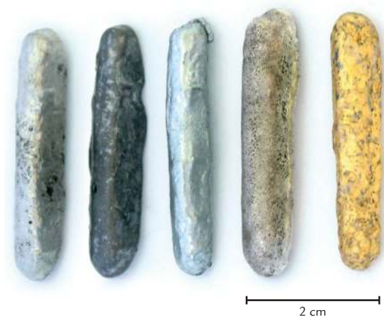
■ Obr. 13 Ingoty zliatin Sn, Pb, Zn, Ag, Au. Zoradené podľa bodu tavenia.
