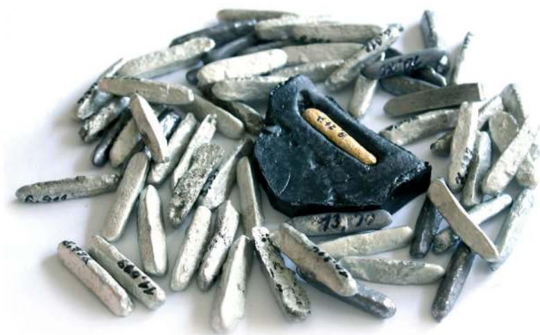
■ Obr. 14 Vyrobená forma so všetkými odliatymi ingotmi (62 kusov).
