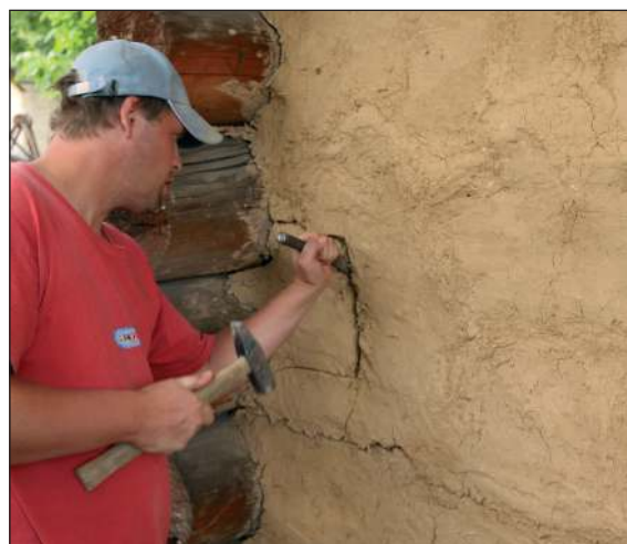
■ Obr. 9 Archeopark Praha-Liboc. Odebírání vzorku omazu s otisky konstrukce v nárožní partii (vzorek 1; foto P. Vařeka).
