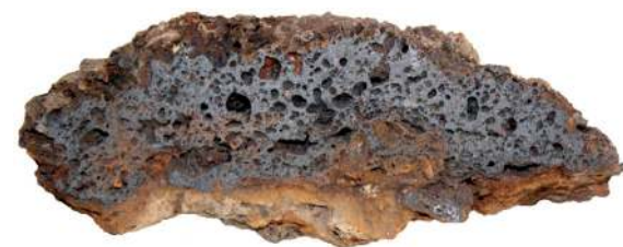
■ Obr. 9 Řez plankonvexním koláčem kovářské strusky
