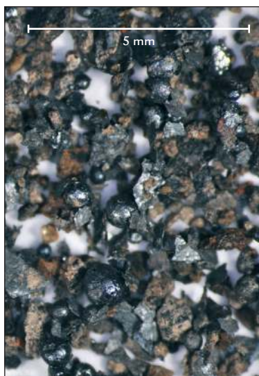
■ Obr. 7 Šupinky lamelárních okují vznikající na povrchu nahřívávaného předmětu.
