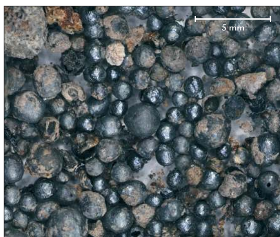
■ Obr. 6 Globulární okuje vzniklé při kovářském svařování.
