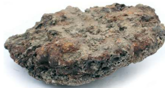
■ Obr. 8 Plankonvexní kovářská struska vznikající ve spodní části výhně, velikost zlomku přibližně 10 × 10 cm.
