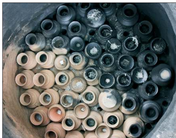
■ Obr. 6 Ostří barevný přechod mezi přední a zadní částí vsádky pece.
